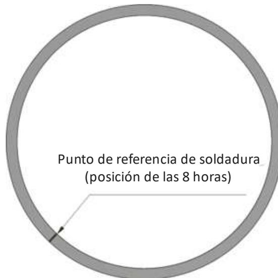
*Figura 37 - Dirección de soldadura dentro del tubo en la posición de las 8 en punto*
