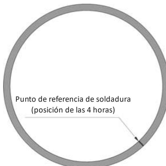
*Figura 36 - Dirección de soldadura dentro del tubo en la posición de las 4 en punto*
