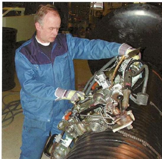
*Figura 31 - Soldadura mediante soldadora externa*
