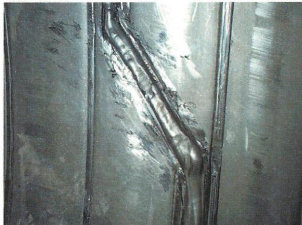
*Figura 38 - Dirección de soldadura en la superficie interior del tubo*
