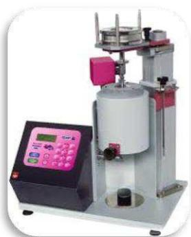
Antes de la producción, las materias primas son evaluadas según el índice de fluidez y prueba de densidad, para asegurar condiciones adecuadas de procesamiento y resistencia mecánica del producto.
