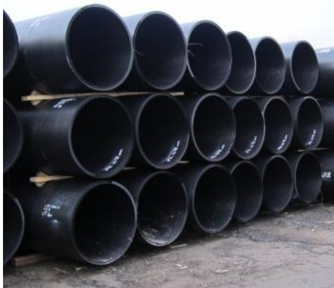
Figura 48 - Acomodação sobre caibros de madeira
